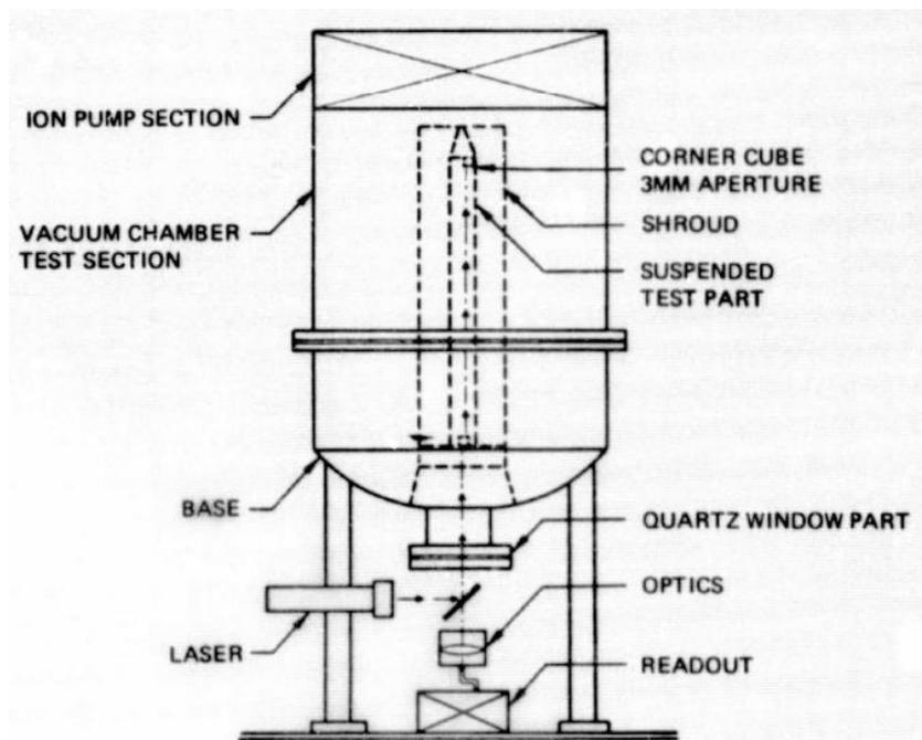
图 2-2 热膨胀系数测试系统结构示意图
