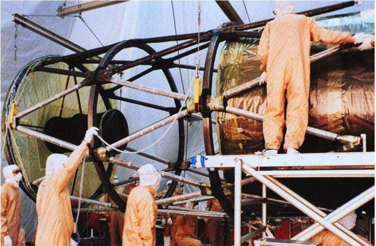
摘要：航天器用各种大尺寸构件都普遍要求超低膨胀系数以保证构件尺寸的稳定性，传统热膨胀系数测试只针对长度 100mm 以下的小试样，已无法满足长度 1m 以上大尺寸构件的超低热膨胀系数测量，多数航天器用大尺寸构件需要精确测量整个构件的超低热膨胀系数。本文对美国波音公司在太空望远镜大尺寸桁架超低热膨胀系数整体测量方面的研究工作进行了综述，以了解国外技术发展状况，给今后开展此方面工作提供参考和借鉴。
