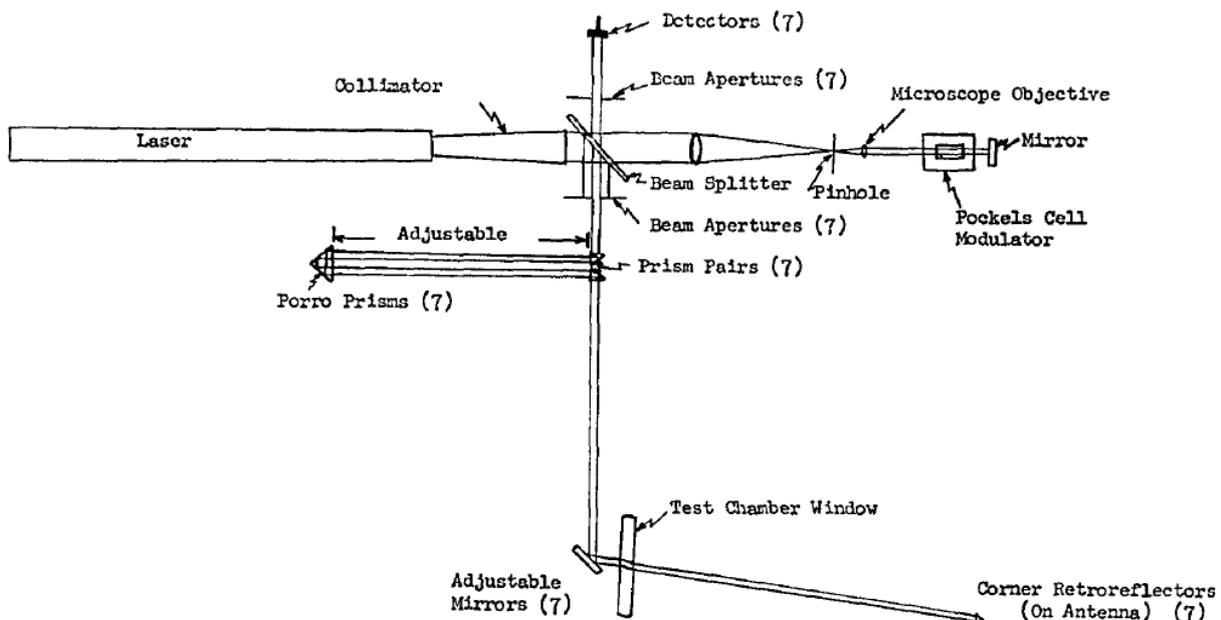
试验腔外测试仪器距离腔体内部天线的距离将近 5m，干涉仪采用了 Twyman-Green 干涉仪，其中参考光束的相位在 13.5kHz 频率处进行调节以便对每个通道进行可反转条纹计数，
