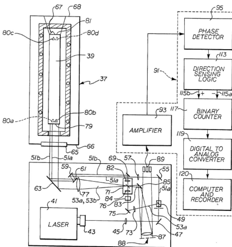
图 3-2 激光干涉法热膨胀仪光路示意图
