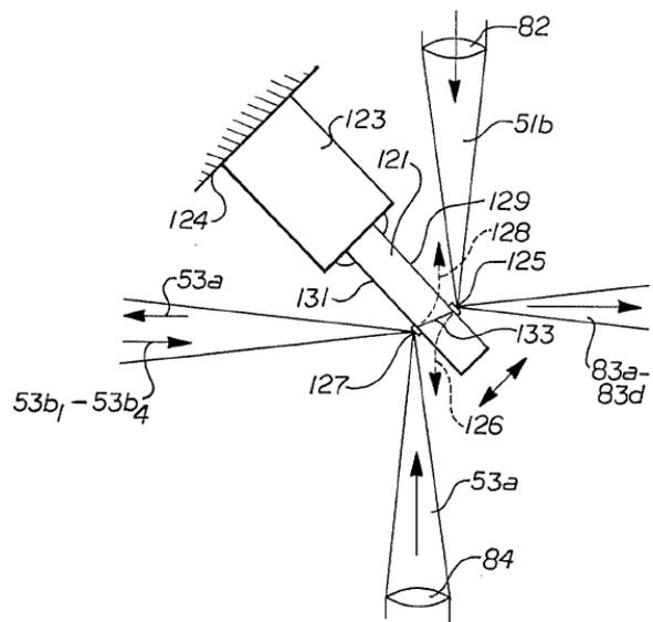
图 3-3 信号光与参考光混合光路示意图
