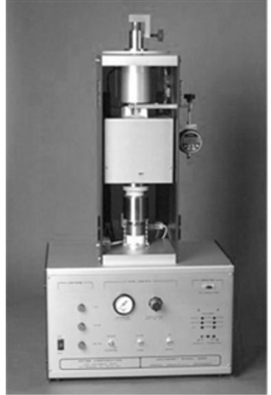
由于采用的是模块式结构，可根据用户要求进行多试样扩展，可以实现多个样品热性能的同时测量，最多可以扩展到同时测量三个样品，有效提高批量测试能力。
