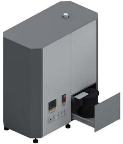
下落式铜卡计混合法作为一种经典测试方法，具有测试试样体积大、更适合块状复合材料测试的特点，而且测试周期短，对一般材料约一个小时测量一个试样，适合大批量试样的连续测量。
