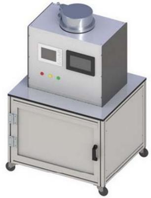
二维光学投影法热变形测定仪的突出特点是可以进行二维投影面内任意两点之间的间距测量，采用高精度数字图像技术可以进行多达16个点间距和夹角测量。对于线性热膨胀系数测量而言，就可以实现最多达到8个样品热膨胀系数的同时测量。二维技术还可以进行面型变形测量，可对粉末冶金烧结成形工艺研究中零部件整体变形的精确测量，另外还可以对高温润湿角和软化变形进行精确的数字化测量。
