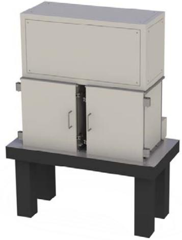
激光干涉法热膨胀测试系统所采用的双频外差式激光干涉法是以激光波长为基准的长度测量设备，是一种绝对测量方法测试系统，在消除了振动、温漂、气体折射率、温度梯度和倾斜变形等一系列影响因素后，此测试系统还可用于其他所有热膨胀性能测试方法和测试设备的校准。
