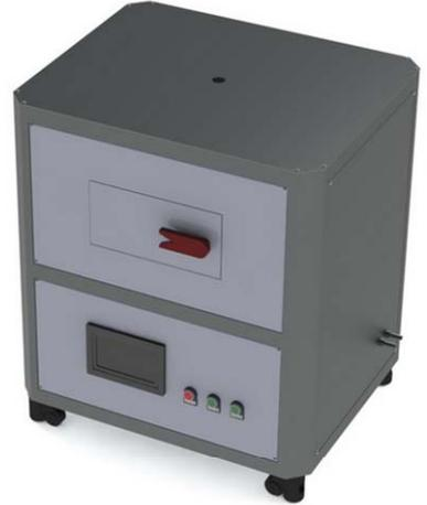
护热板法导热系数测定仪采用了独特的温差探测技术，比热电偶型温差热电堆灵敏度更高，更能有效保证护热效果的实现和高精度导热系数测量。护热板法导热系数测定仪采用的是单试样结构，操作简便。同时配备了专门用于热流计的附件和引线接口，能满足大多数热流计的准确校准。
