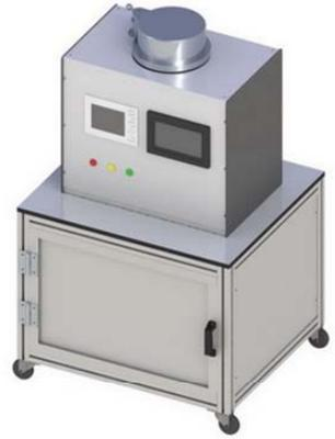
超高温3000℃热膨胀仪采用试样卧式结构，投影光源配备的是氮化镓绿色LED，LED点光源经过光学系统形成平行光束均匀照射到被测试样并在探测器上形成投影，即使在高温物体发光的背景中也能产生极高解析度，有效防止试样位置改变而造成镜头放大倍率地波动，确保测量精度。光学探测器采用了高速CCD可以获得极高的采样速度，目标物观测器采用了视觉影像传感器，可提供逼真的样品外型影像，便于试样安装。
